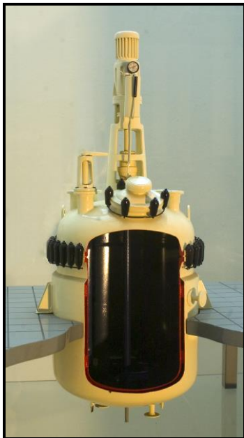
Abbildung 29: Rührmaschine. Hüttenmuseum Thale. Der Behälter – und Apparatebau gehört zu den zwei Produktionsbereichen, die heute noch existieren. Die Nachfolgefirma heißt THALETEC GmbH und stellt heute innen emaillierte Behälter und Apparate für die Chemie – und Pharmaindustrie her. Foto: Jürgen Meusel
